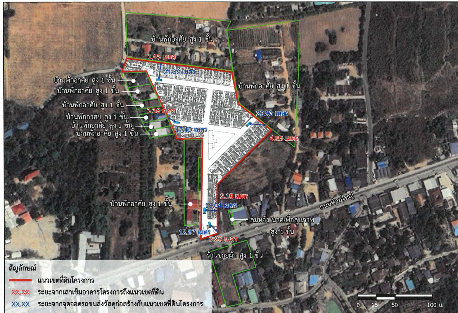
รูปที่ 4.1.6-1 ผังแสดงระยะห่างเสาเข็มกับแนวเขตที่ดินโครงการ และระยะห่างรถบรรทุกกับแนวเขตที่ดินโครงการ ในระยะก่อสร้าง
