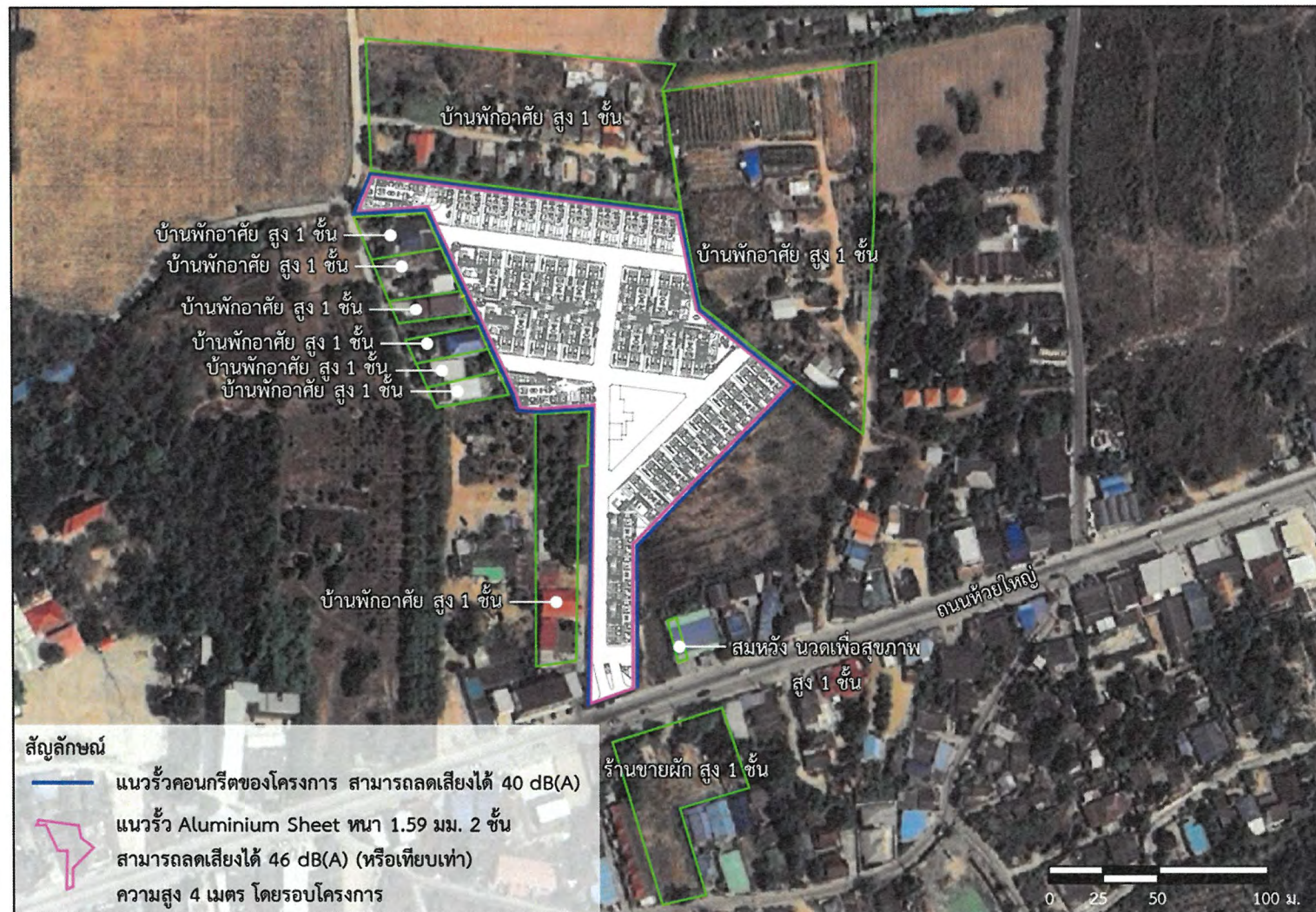
รูปที่ 4.1.5-4 ผังแสดงแนวรั้วโครงการและแนวรั้ว Aluminium Sheet ที่เป็นกำแพงกันเสียงโดยรอบโครงการในช่วงงานโครงสร้าง
